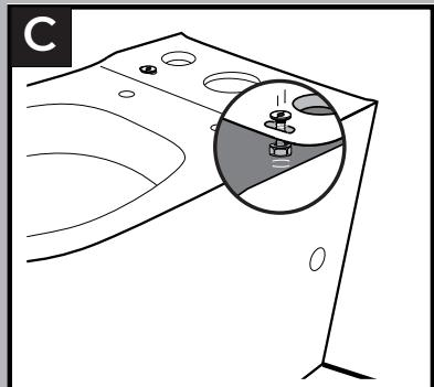
Coloque la taza ajustada al desagüe y una vez colocado el inodoro en su posición correcta, proceda al atornillado por ambos lados del mismo. (Figura D)
